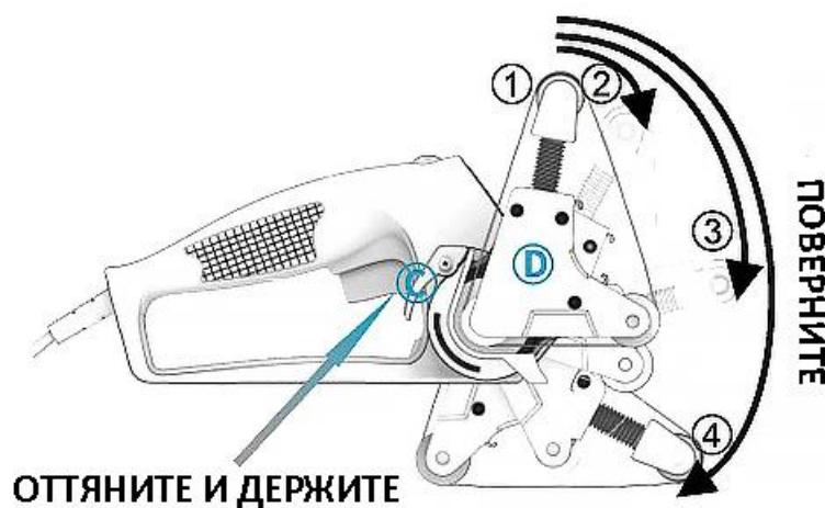
Оттяните и держите рычаг блокировки (C), поверните платформу машинки (D) до нужного положения. Отпустите рычаг (C).
